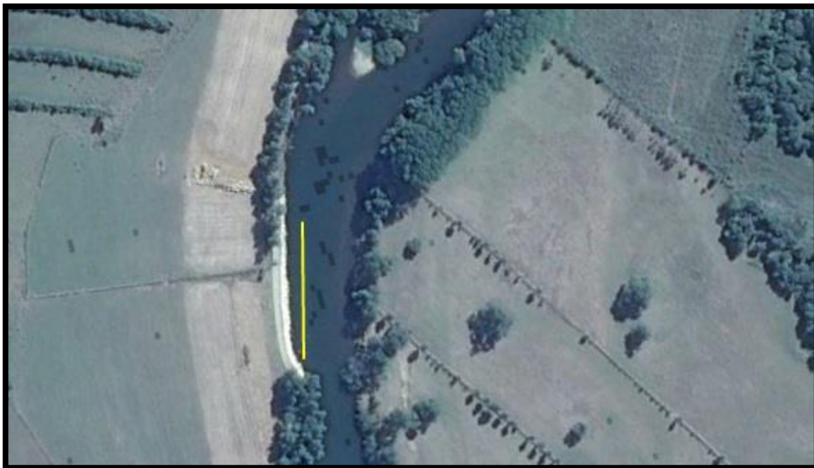
Figura 2. Río Cruces, sector Cahuincura. La línea amarilla representa el largo de la muralla construida durante el año 2016 (longitud aproximada: 100 m).
