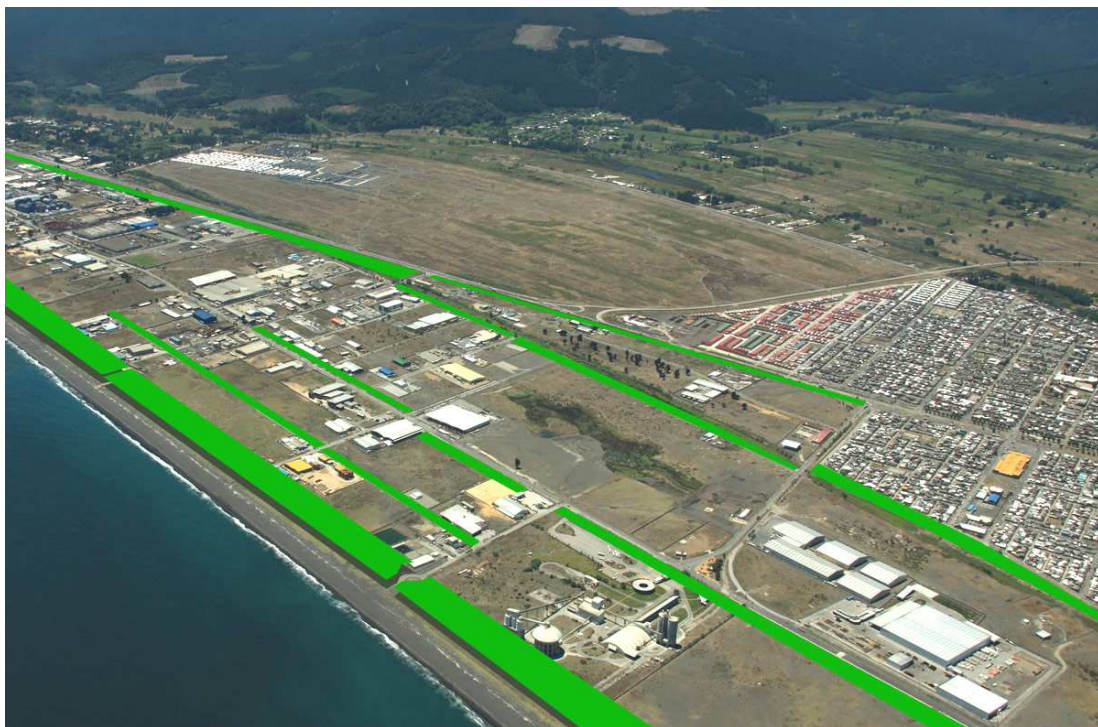
Figura 3.1-4: Esquema Zona de Protección Costera y barreras de mitigación tsunami.
