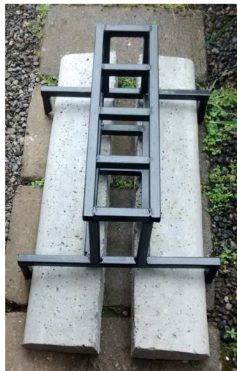
Figura 4.1.3.2. Armazón de fierro usada para la instalación de las cuatro trampas en un canal submareal del estuario del río Cruces.
