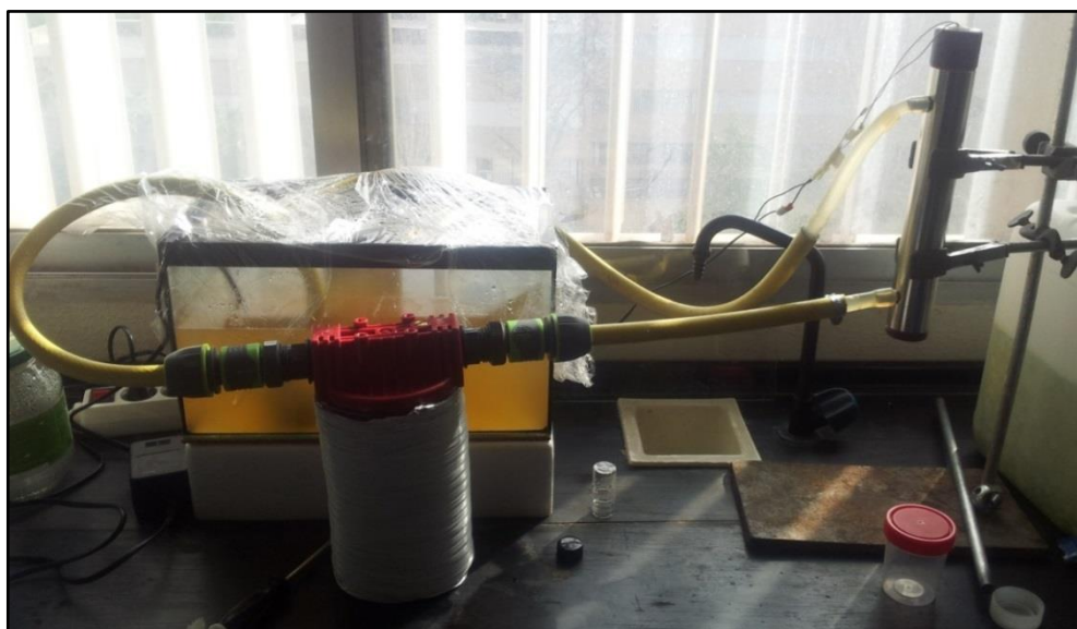
Figura 4.16. Sistema de filtración equipado con luz UV.
