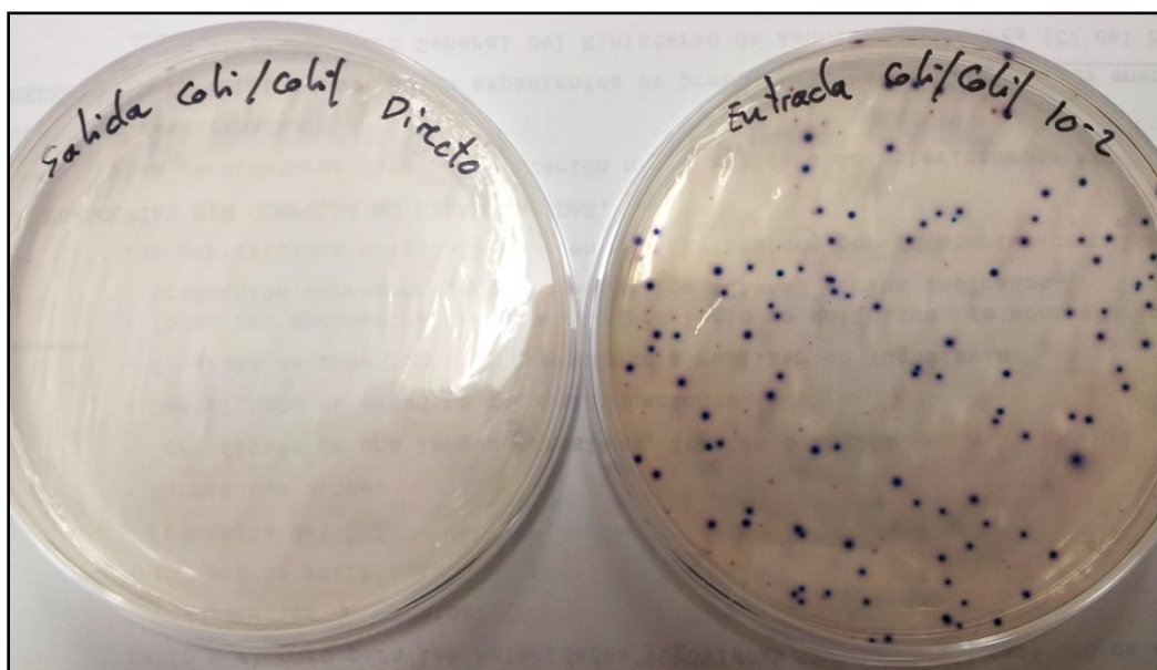
Figura 4.65. Cultivos para coliformes fecales y E. coli en muestras de agua a la salida (izquierda) y entrada (derecha) del humedal HF.
