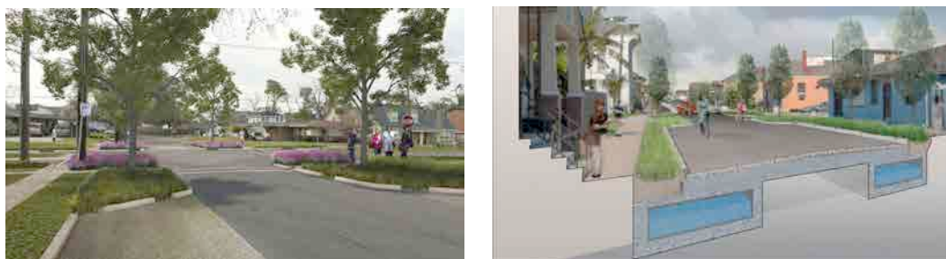
Figura 8.59 Ejemplo de mejora de carreteras en Nueva Orleans, más áreas arboladas y verde para incrementar la permeabilidad del sistema. Figura 8.60 Sección del proyecto de acuerdo con el Plan de Agua Urbana. Pavimentaciones permeables, canales y colectores subterráneos para eliminar el exceso de agua.
