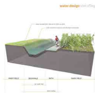
Figura 8.54 Orillas de los canales que pueden convertirse en terrazas arboladas. En algunos casos, hay suficiente espacio para insertar una vía peatonal, instalaciones y espacios públicos. Figura 8.55 Sección tipo del canal.
