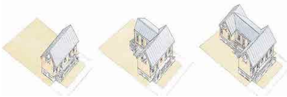
Figura 8.38 Ampliaciones de vivienda a través de adición por fases.
