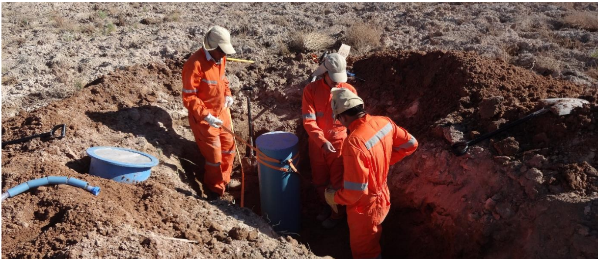
Figura-6: Preparación para girar el lisímetro.
