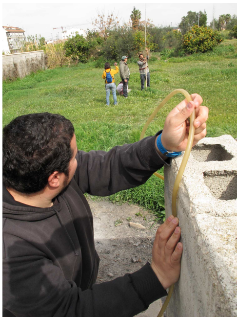
Figura 116. Cuarto recorrido del Proyecto Iskurna, 31 de mayo de 2012. Transportando la altura de las inundaciones utilizando un nivel de agua.
